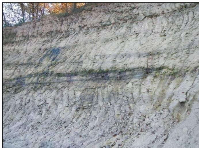
Front d'exploitation avec passage marnes et suintements d'eau
